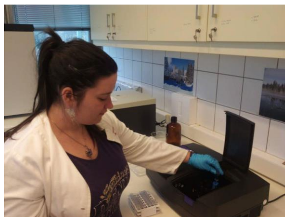
10. ábra Foszfortartalom mérése a kísérleti talajmintákból Balra: talajminták bekeverve az AL (ammónium-laktát)-oldószerrel, jobbra: spektrofotométeres meghatározás (Fotó: Kotroczó, 2015)
