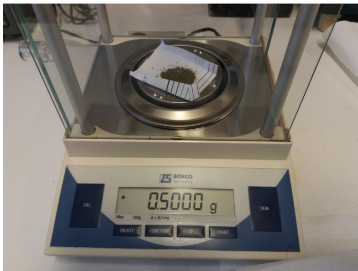
11. ábra: Növényminták kimérése analitikai mérlegen elemtartalom-vizsgálathoz (Fotó: Dudás, 2015)
