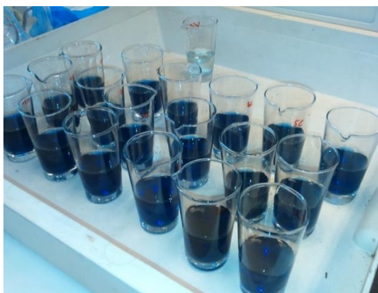
10. ábra Foszfortartalom mérése a kísérleti talajmintákból Balra: talajminták bekeverve az AL (ammónium-laktát)-oldószerrel, jobbra: spektrofotométeres meghatározás (Fotó: Kotroczó, 2015)
