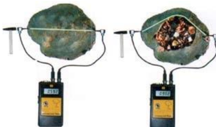
4. ábra: A hang terjedési ideje egészséges és korhadt fában, rostirányra merőlegesen. A hang egy lehetséges útját a szürke vonal jelzi (Divós & Szalay 2002).
