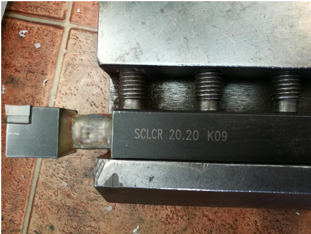
3.2. ábra A módosított, nyúlásmérő bélyegekkel ellátott készár
