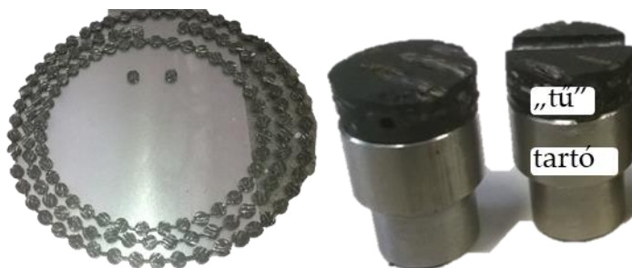
3.14. ábra: A betétből kivágott és a rögzítéshez fém tartócsapokra ragasztott minták
