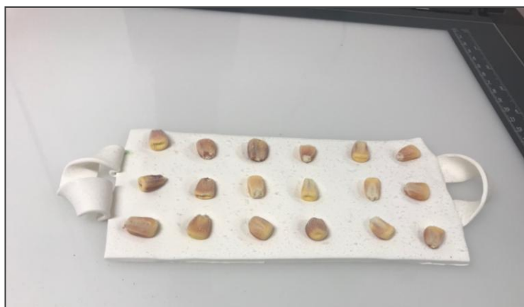
17. ábra. Süthető gyurmából készült tálcára helyezett kukorica magok
