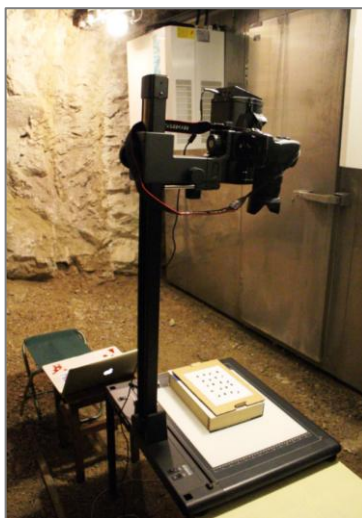
2. ábra. Kartonlapra helyezett magok mérése hőkamerával az Esztramos-hegy bányájáratában
