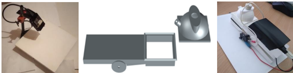
1. ábra – Tervezett prototípusok képe, balra a mérőállvány, középen a mérőfej továbbfejlesztett modellképe, jobbra az elkészült verzió
