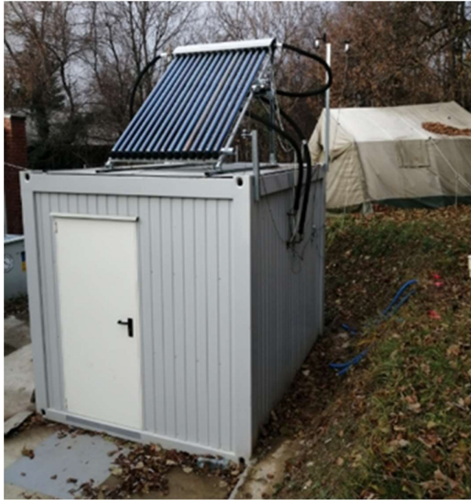
26. ábra, Katonai tábori épület modell az egyetemi épületgépészeti laboratórium területén
