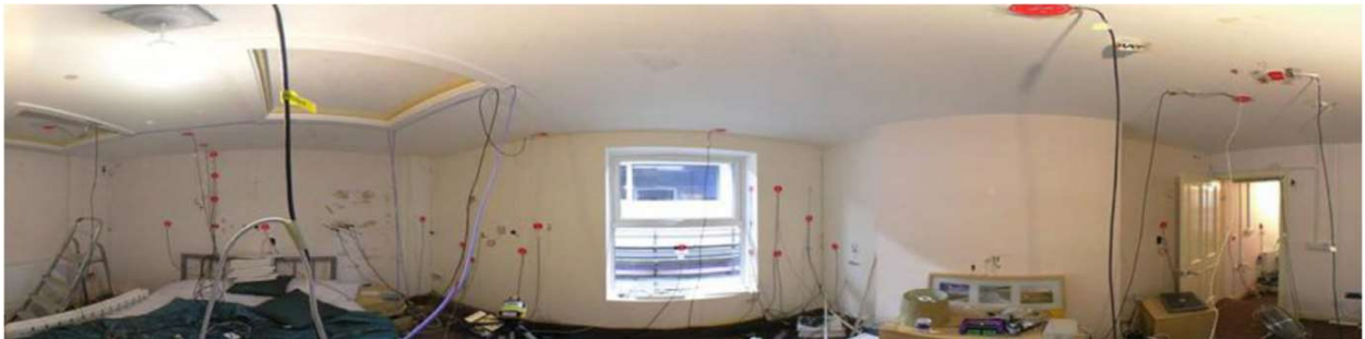
21. ábra, Hőáram- és hőmérséklet- érzékelők és elrendezésük (forrás: YINGCHUN et al. 2019)
