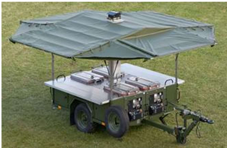
7. ábra, GTMM16 Gamma Tábori Moduláris Mozgókonyha (forrás: respirátor.hu)
