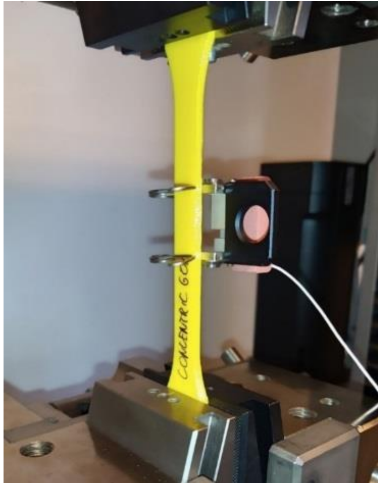
3.7. ábra Az extenzométerrel felszerelt próbatest
