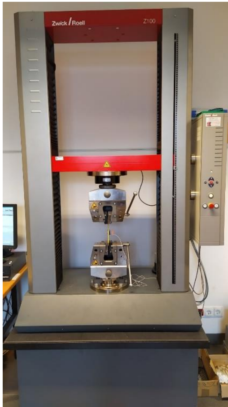
3.5. ábra A szakítások során használt Zwick/Roell Z100-as típusú szakítógép.
