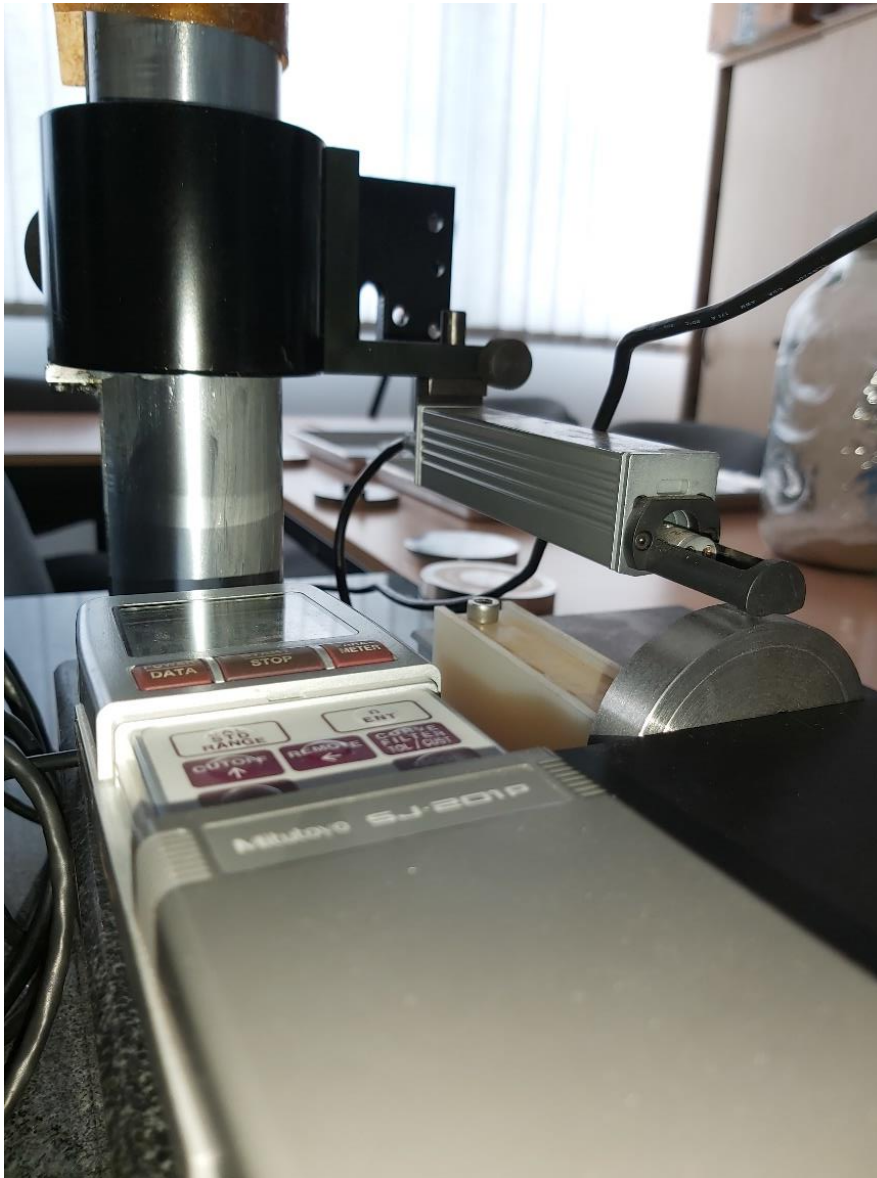
3.27. ábra Érdességmérő berendezés
