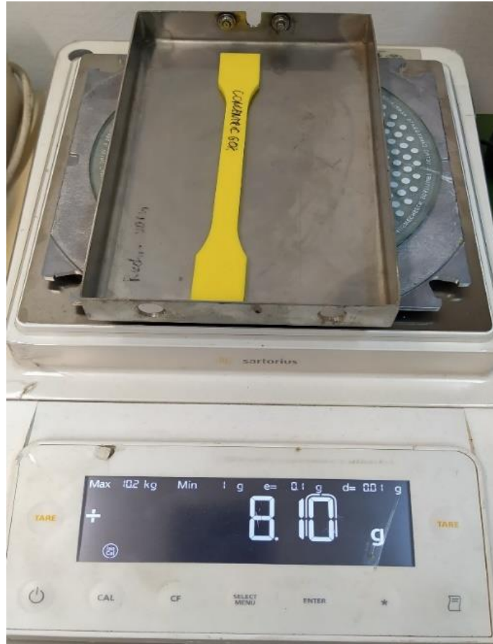
3.6. ábra A próbatestek tömegének mérése
