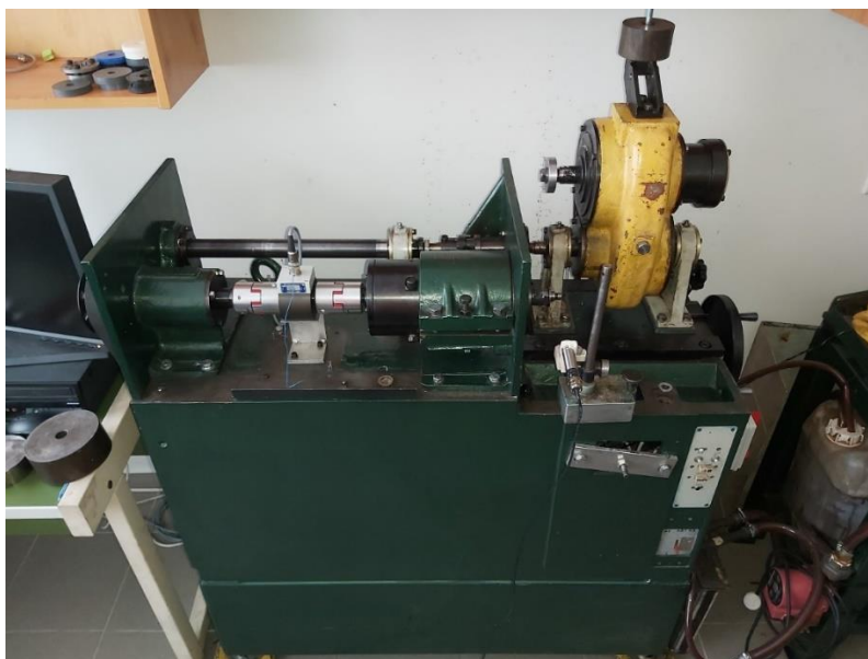
2.6. Ikertárcsás elven működő hajtástásvizsgáló fékpad
