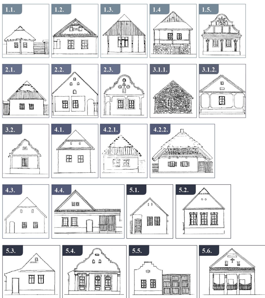
17. ábra: Hazai területtípusok hagyományosan jellemző homlokzati kialakításai (saját szerkesztés, Meggyesi, 1986)
