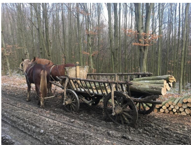
9. ábra: Felemelt állapotban való közelítés hagyományos lőcsős szekérrel (Bakonybél, 2021)
