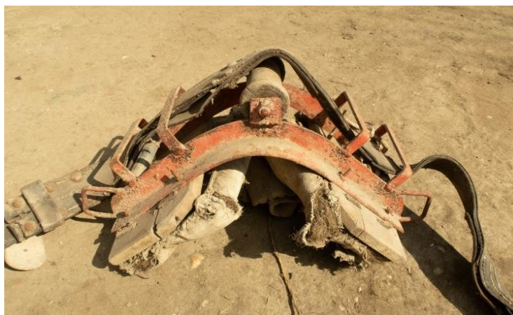
8. ábra: ERTI-fejlesztésű közelítő kerékpár tartozéka, amely a ló nyereghelyére/hátára illeszkedett (Vasvár, 2021)
