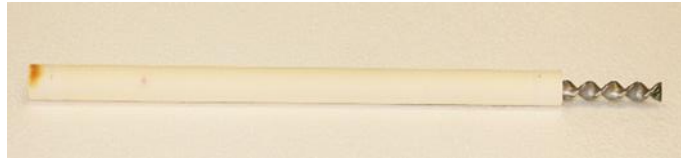
2.ábra: Statikus keverő beépítése 5 nm-es kerámiacsőmembránba
