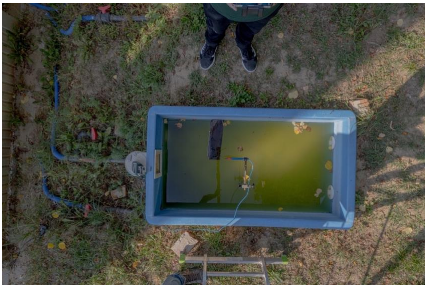
27. ábra: A medencébe helyezett szélességmérő, DJI AIR S2 drón által készített nadír fényképe 2 méter magasságról.
