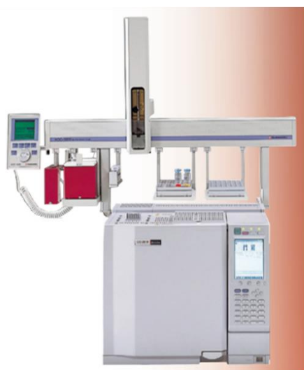
15. ábra A borok TDN tartalmának méréséhez használt automata HS-SPME mintaelőkészítő egységgel ellátott GC-FID készülék. A HS-SPME eljárás szematikus elvi ábrája.
