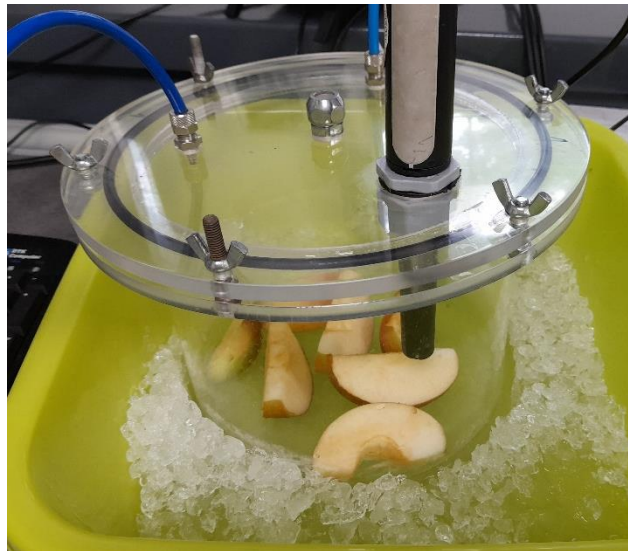
28. ábra: Almaszeletek légzésintenzitás mérése módosított atmoszférában
