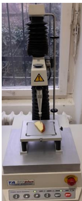
33. ábra: SMS-TA XT készülék fresh-cut alma mérés közben 'needle' mérőfej alkalmazásával
