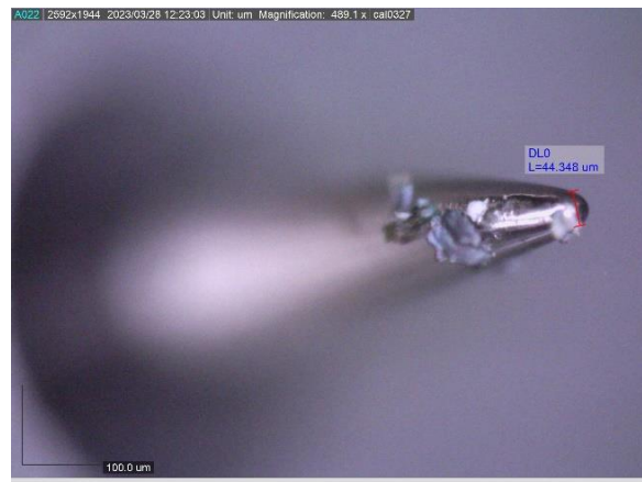
22. ábra: A mechanikai perforáció létrehozásához használt tű digitális mikroszkópos képei (tű hegyére fókuszálva)
