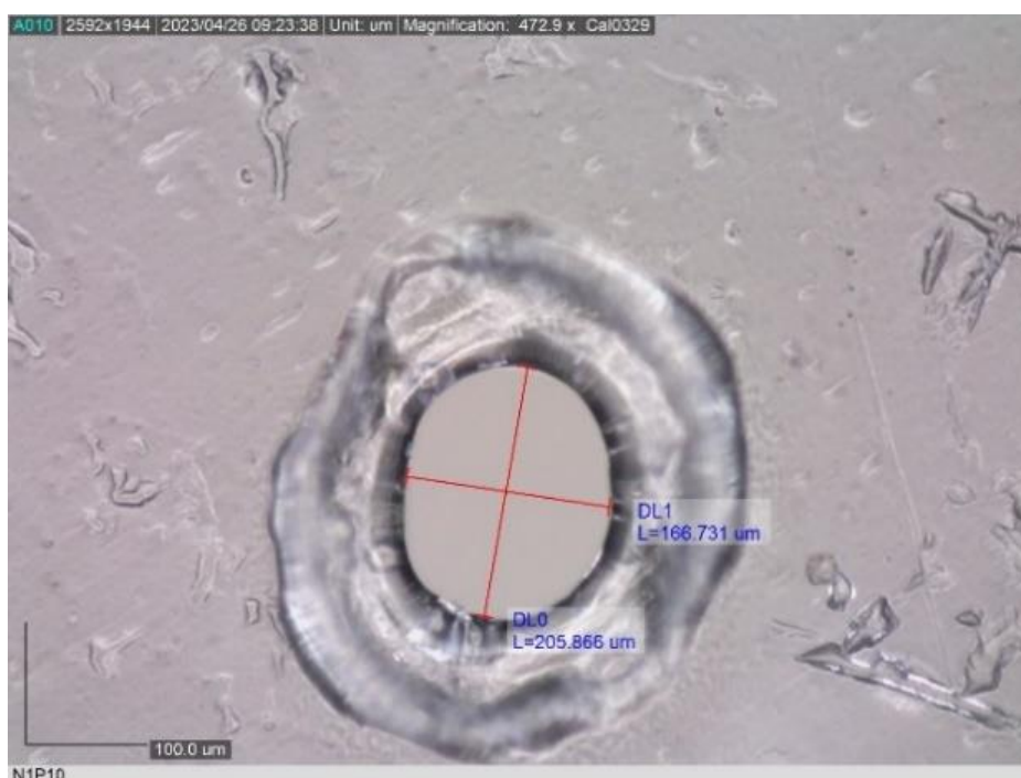
44. ábra: Lézerrel perforált mikroperforáció digitális mikroszkóppal készített képe
