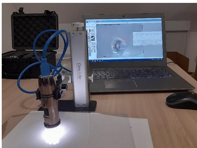
26. ábra: Mikroperforációk vizsgálata digitális mikroszkóppal
