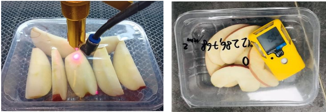
32. ábra: Bal: lézer mikroperforáló berendezés működés közben, jobb: oxigénkoncentráció változás nyomonkövetése a csomagban
