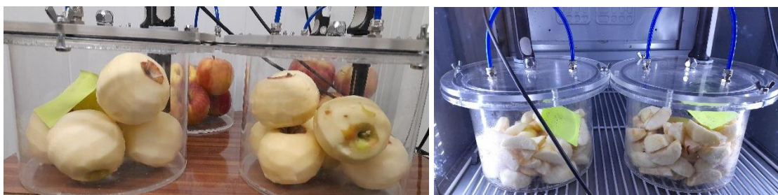
15. ábra: Légzésintenzitás mérése különböző feldolgozottsági fokok és különböző hőmérsékletek (bal: 20°C, jobb: 5°C) mellett kontroll és 1-MCP-vel kezelt mintáknál
