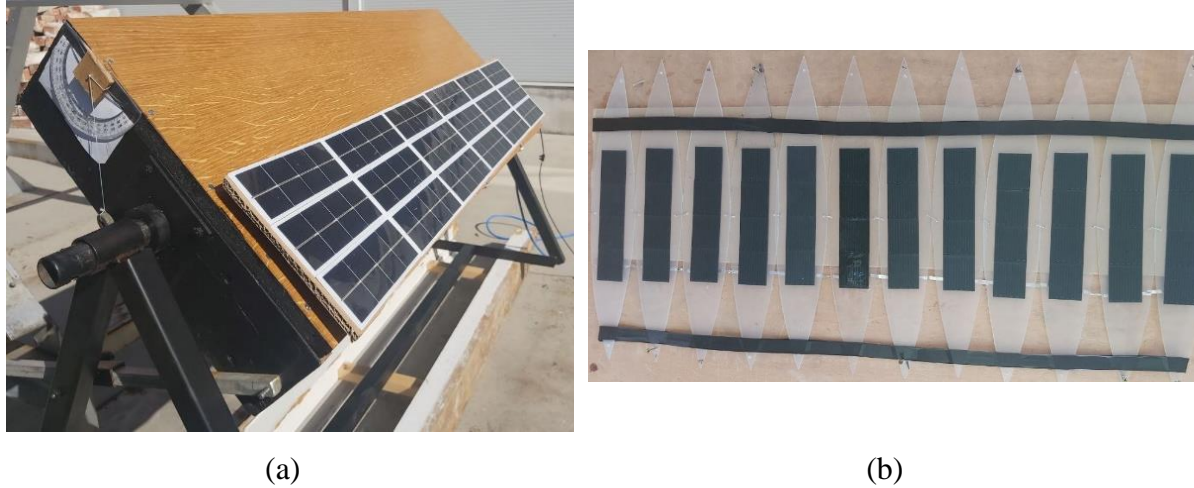
Fig. 3.4. Flat PV module (a) monocrystalline PV module, (b) thin film PV module
