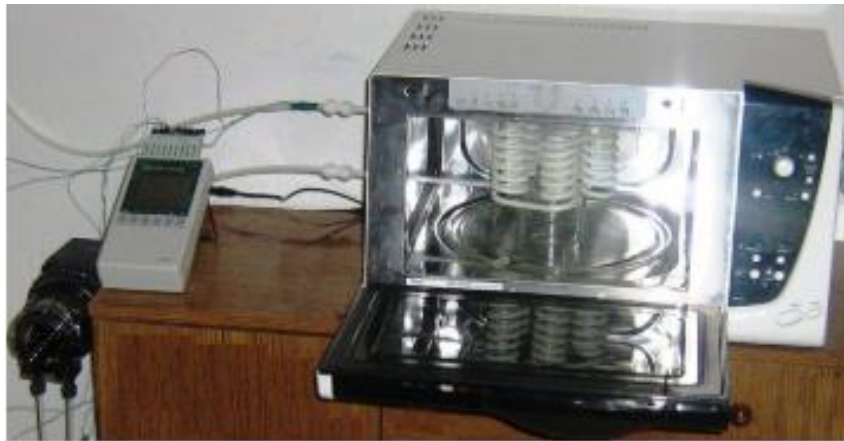
Fig. 2.5. Microwave milk pasteurization (Korzenszky et al., 2013).
