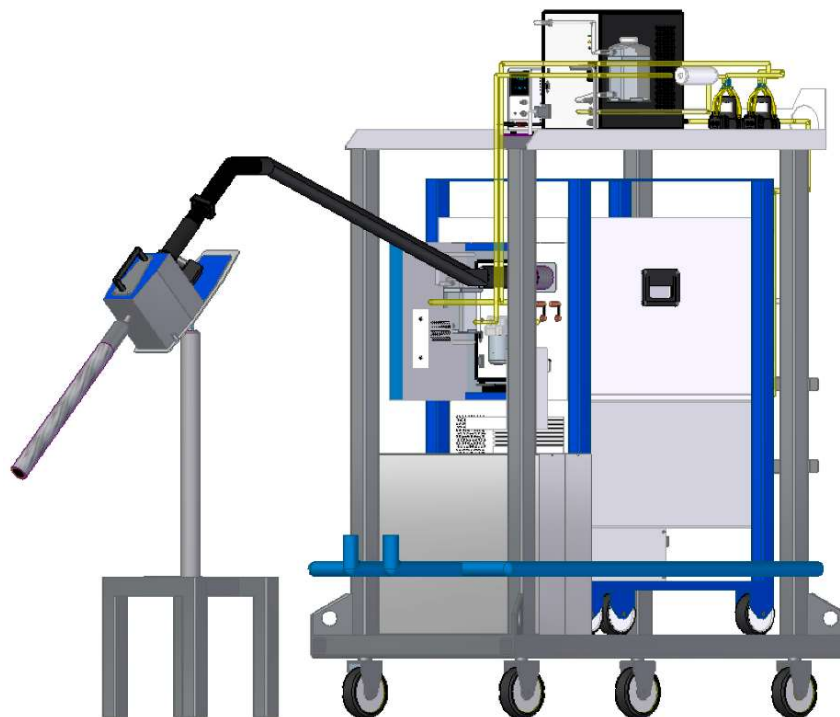
4.9. ábra Az AVL részecskeszámláló (APC) 489 CAD modellje, fejlesztett N-elrendezéssel (Forrás: Bíró Norbert).
