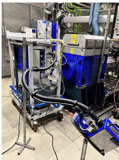
3.27. ábra AVL 489 részecskeszámláló (Forrás: Biró Norbert)
