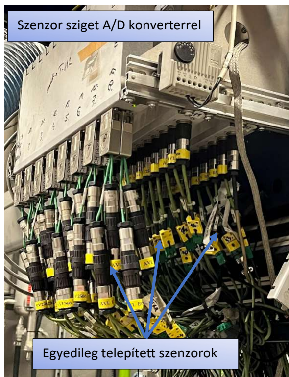
3.13. ábra Egyedileg telepített szenzorok analóg-digitális konvertere és bemenete (Forrás: Biró Norbert)
