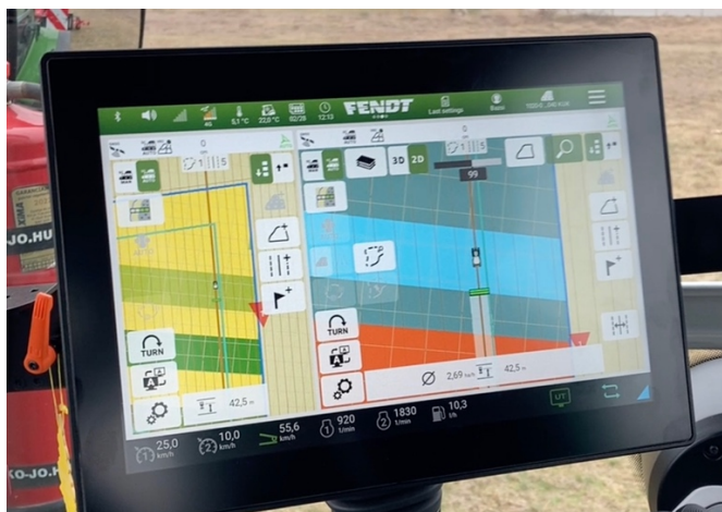
7. ábra Differenciált kijuttatás vezérlése egy Fendt traktor FendtOne terminálján
