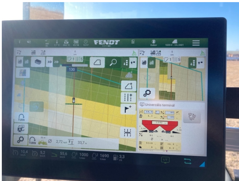
2. ábra FendtOne terminál a kijuttatási tervvel, az elvégzett munkával és a munkagép vezérléssel
