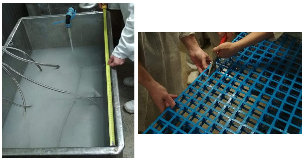
19. ábra: A kísérlethez használt pácolókád és a húsminták közé elhelyezett távtartó rács
