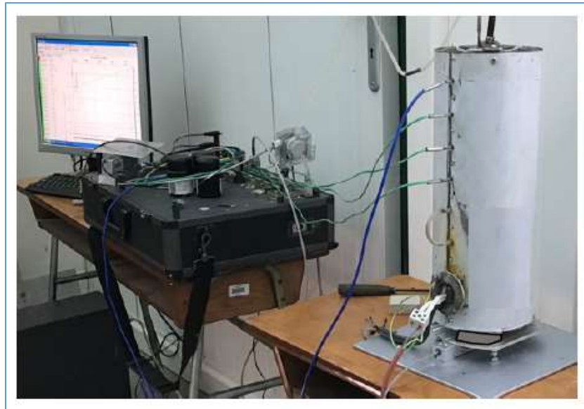
40. ábra A közvetlen villamos fűtésű, gázvisszavezetésre alkalmas egység (1300 °C-ig működtethető)
