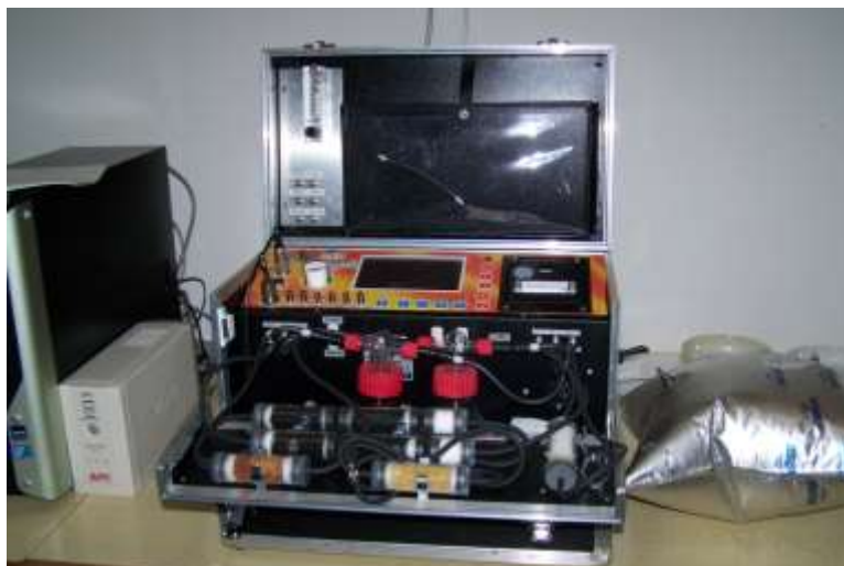
36. ábra Hordozható típusú gázanalizátor (VISIT 03H)
