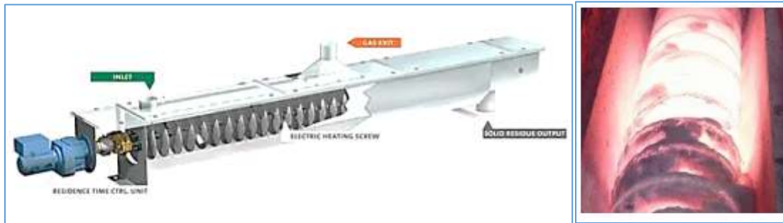
11. ábra Csigás reaktorral rendelkező megoldás 5
