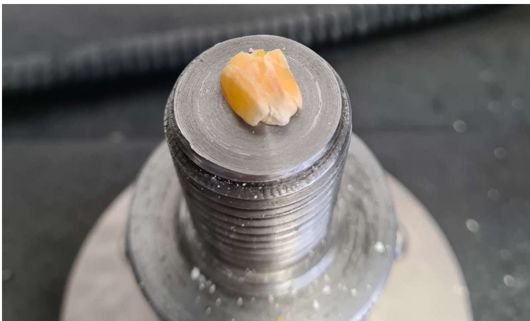
3.15. ábra: Kukoricaszem nyomóvizsgálata
