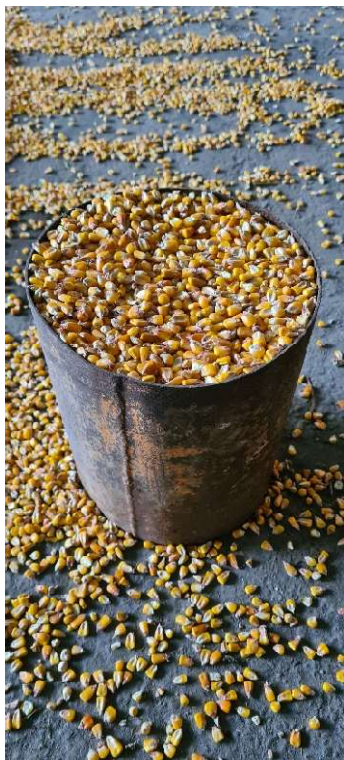
3.18. ábra: Kukorica rézsűszögének mérése acélhenger segítségével
