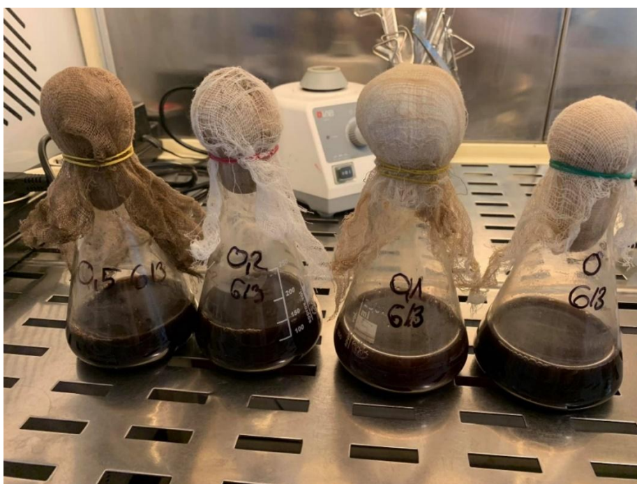
29. ábra: A Y. lipolytica 6/3 élesztő fermentleve a fermentáció utolsó napján különböző Mn^{2+} koncentrációk alkalmazása mellett
