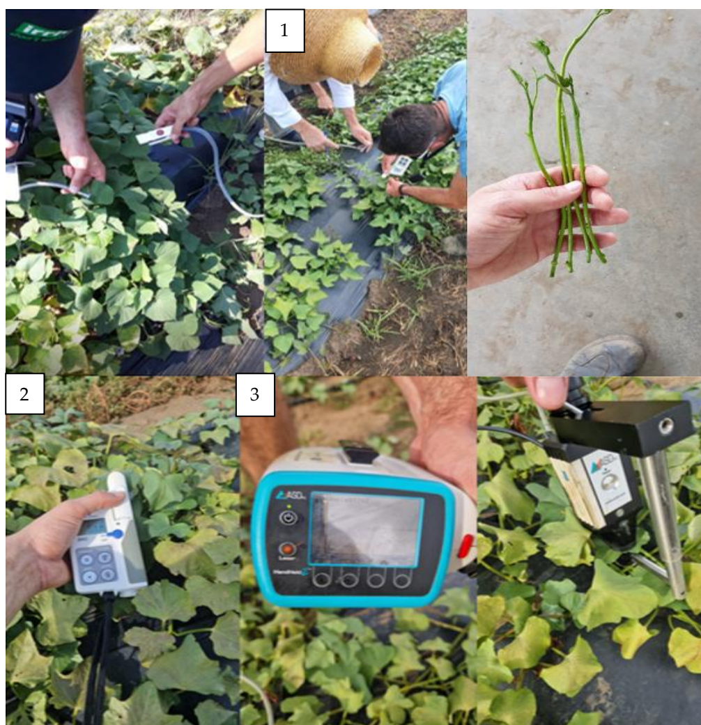
8. kép Növényfiziológiai mérések, Klorofill fluoreszcencia (1), SPAD (2), Spektoradiométer (3). Forrás: saját fotó
