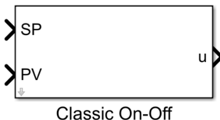
4.31. ábra Alrendszerbe foglalt kétállású szabályozó Simulink környezetben
