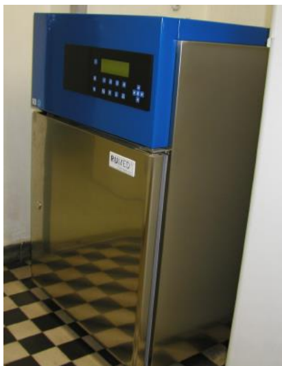
11. ábra A Rumed 3301 (Rubarth Apparate GmbH) típusú klímakamra
