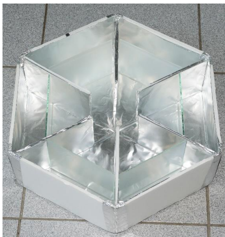
33. ábra: A külső (perifériális) egységbe hat darab matt üveglapot is helyezettünk, hogy azon minél homogénebb módon szűrődjön át a fény a rovarok számára (Fotó: Egri, 2020)
