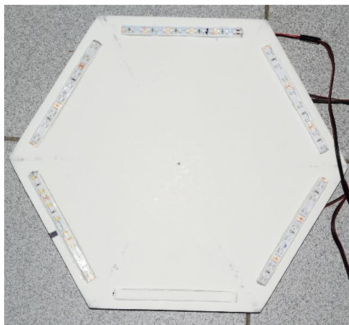
34. ábra: A mérőállomás tetejébe (alsó nézet) helyeztük a ledszalagokat, amelyeket ismétlésenként újra randomizáltuk (Fotó: Egri, 2020)
