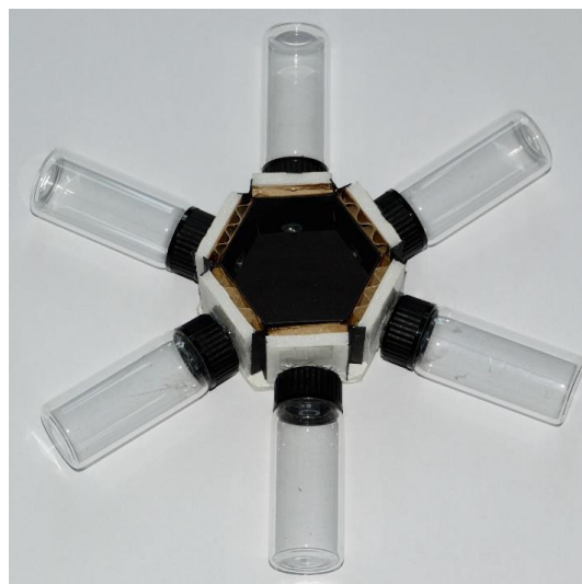
32. ábra: A központi egységbe helyeztük a tesztelt állatokat, amelyek a fényforrással megegyező helyen lévő fiolák közül választhattak (Fotó: Egri, 2020).
