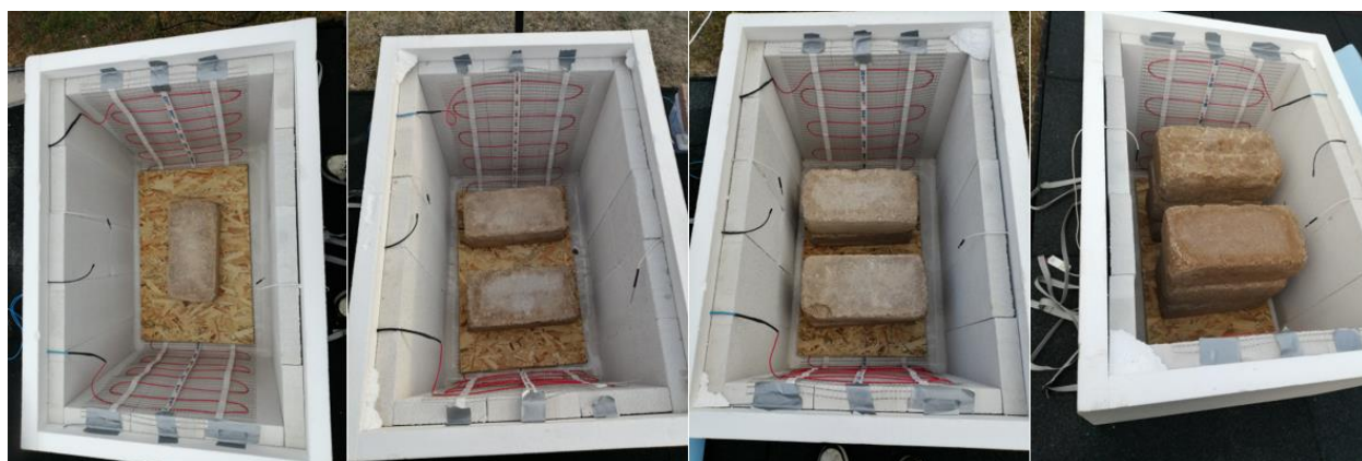
3.12. ábra Hőtároló tömegek módosítása különböző mérések előtt
