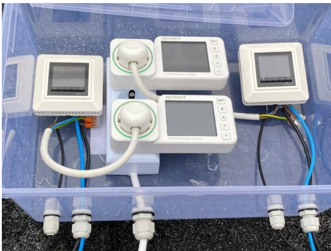
3.11. ábra Fűtés szabályozás és elektromos fogyasztásmérés a kisminta modellépületekben
