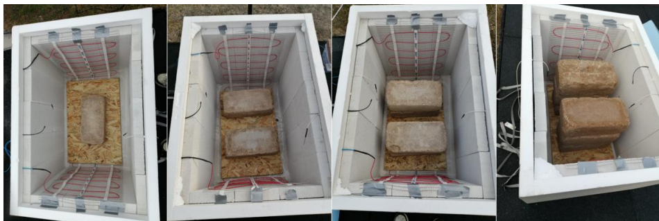
2.3. ábra Hőtároló tömegek módosítása különböző mérések előtt
