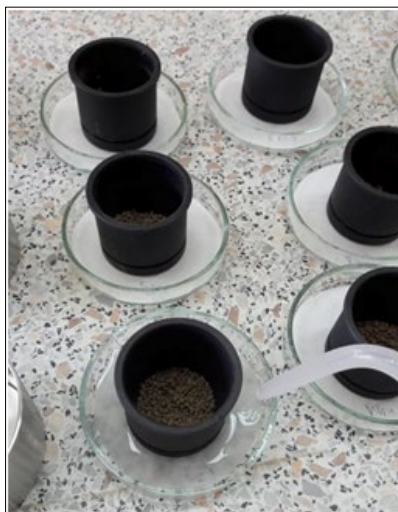
5. ábra. A minták előnedvesítése kapilláris úton, dupla szűrőpapírral
