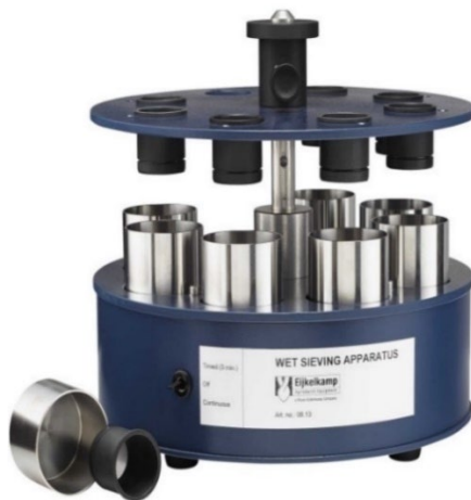
4. ábra. A makroaggregátum-stabilitás meghatározására használt egyszítás Eijkelkamp- nedvesszita készülék
