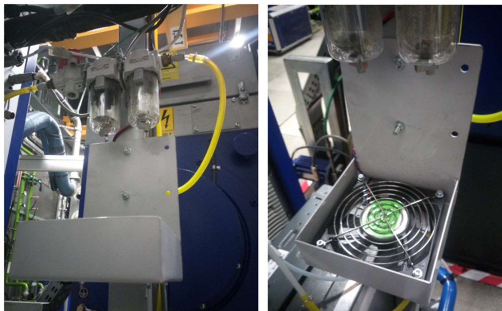
3.5. ábra: A vízleválasztás kialakítása (Forrás: Szöllősi Dániel)
