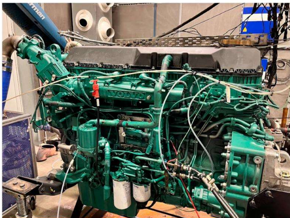
3.20. ábra: Volvo D13-TC motor, AVL HD Load System 500kW-os motorfékpadra telepítve.
