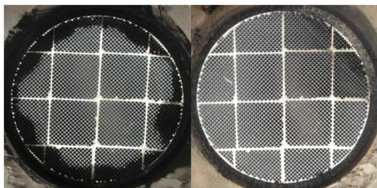
4.41. ábra: Részecskeszűrő bemeneti felülete a regeneráció után, jobb oldalon vízbefecskendezéssel, bal oldalon pedig nélkül
