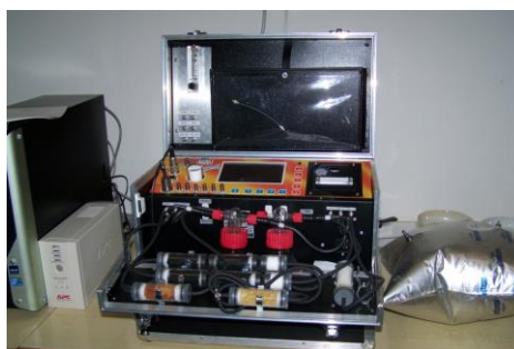
3. ábra VISIT 03H gázelemző berendezés (MGI labor)
