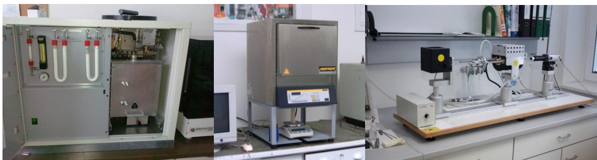
2. ábra ELEMENTAR VARIO X elemi összetétel vizsgáló készülék, Nabertherm égetőkamra, HESSE 154 hevítőmikroszkóp (MGI labor)
