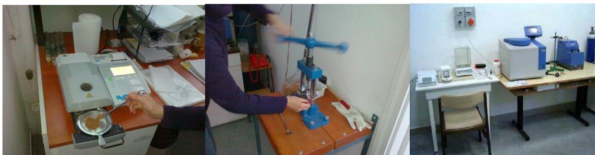
1. ábra METTLER TOLEDO nedvességmérő, tömörítőprés, IKA-WERKE C2000 kaloriméter (MGI labor)
