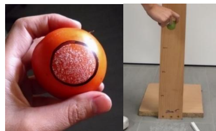
27. ábra: Az ejtővizsgálat kivitelezése (saját forrás)
