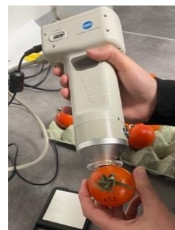
30. ábra: Színmérés a Minolta CR-400 berendezéssel
