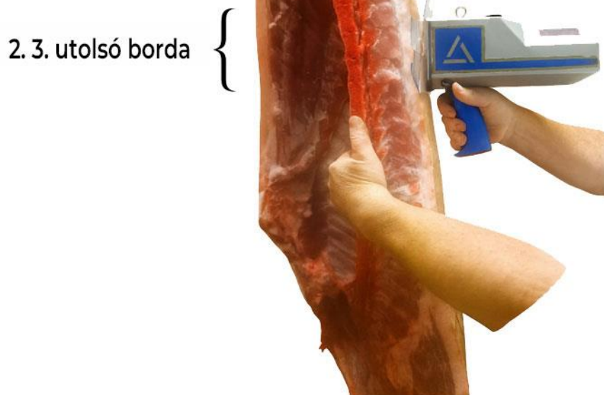
5. melléklet: A mérési pont jellemzően a hasított gerincoszloptól (6-7 cm-re) a 2. és 3. utolsó borda közötti szakaszon méri a bőr alatti szalonna és az alatta lévő izom vastagságát
