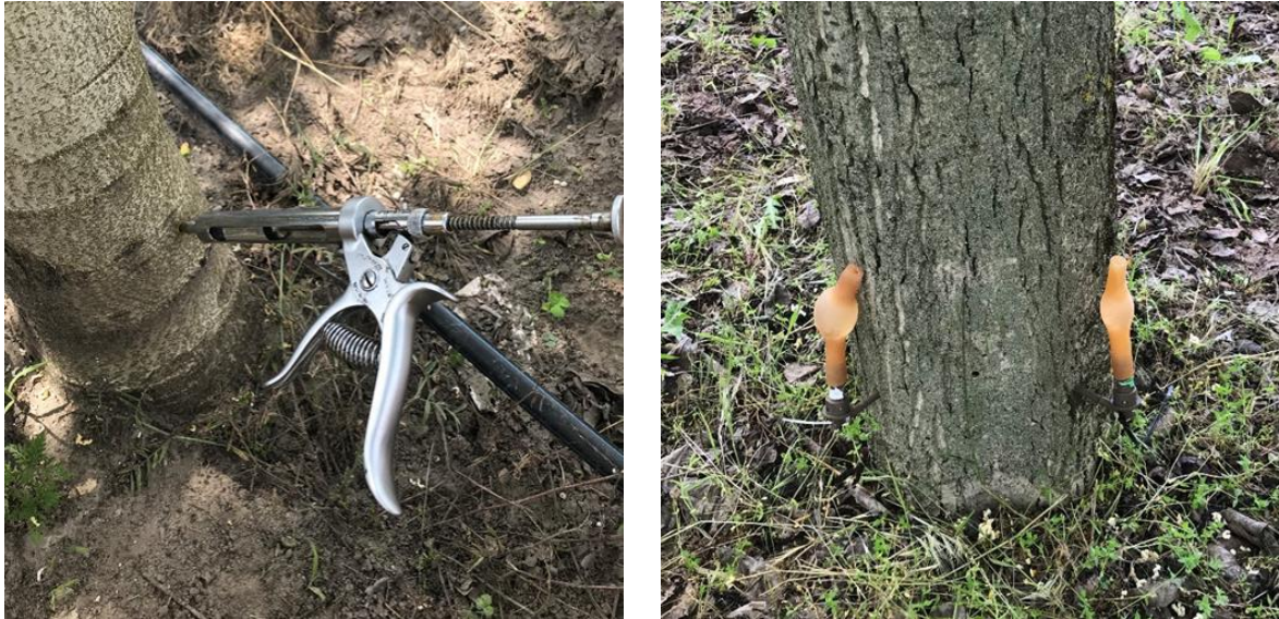
27. ábra Treenject típusú injektáló készülék balra (saját fotó, Taksony, 2021) és YnjectGO (latexcső) jobbra (saját fotó, Szelevény, 2022)
